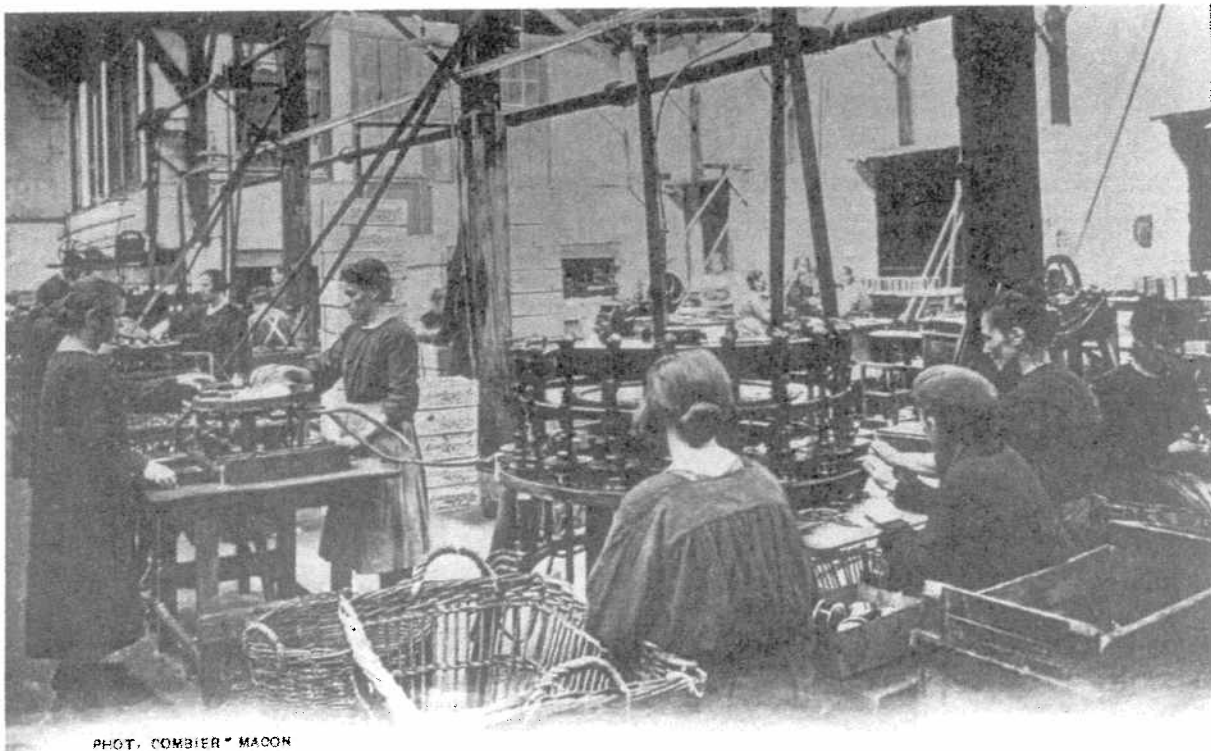
17. SOCIETE SAUPIQUET – Fabrication des Boîtes Métalliques (Machines à Souder)
